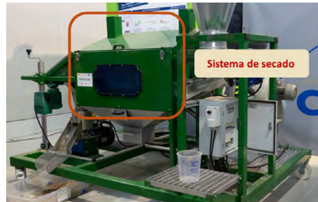
Ilustración 4: Máquina prototipo densificadora con sistema de secado integrado
